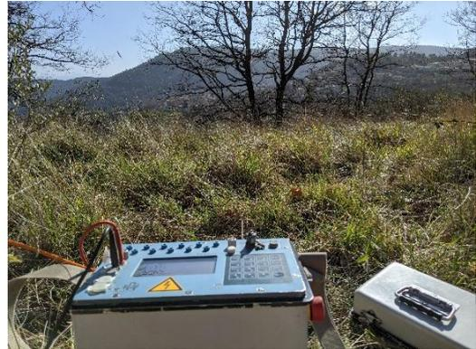
Illustration 101 : Photo du résistivimètre lors de l'acquisition le long de PE2.
