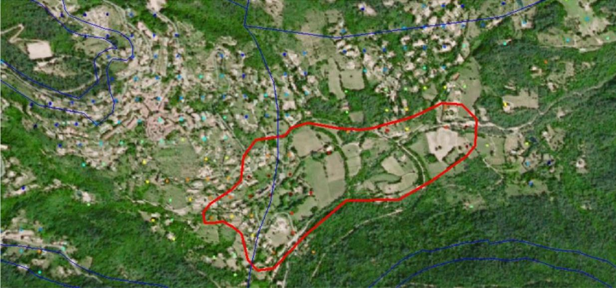
Illustration 20 : Zone anomaliq ue avec déformées verticales moyennes supérieures à 4,5 mm/an
